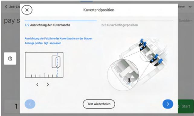
Auf die Schaltfläche **[Test wiederholen]** tippen, um ein weiteres Kuvert abzurufen. (Hinweis: Die obere Einheit muss geschlossen sein.) Die Ausrichtung erneut prüfen. Auf den Pfeil unten rechts tippen, wenn die Ausrichtung in Ordnung ist.
