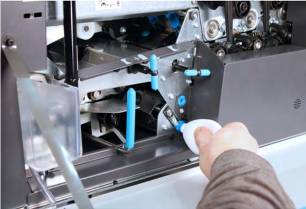
6. Zum Reinigen der Ausgangsfotозelle den Balg in das Loch für die Ausgangsfotозelle setzen und einige Male fest drücken, um den Staub von der Ausgangsfotозelle zu blasen.
