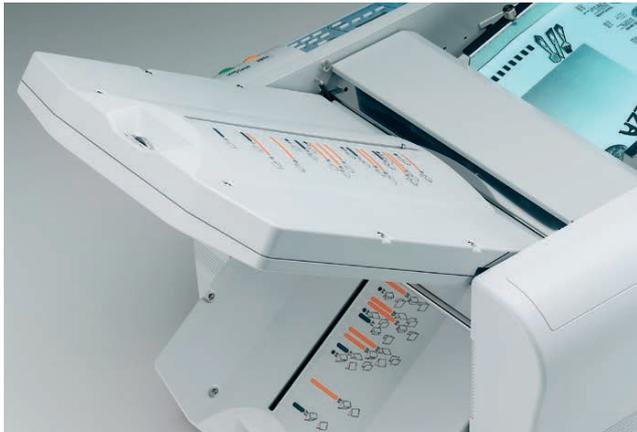
**FALZARTEN PER KNOPFDRUCK** Per Tastendruck wird die Falzart gewählt und die Anschläge in den Falztaschen werden automatisch per Elektromotor angefahren.
