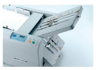
**PAPIERANSCHLÄGE** Die Einstellung der Falzart erfolgt über leicht zu bedienende Papieranschläge an den Falztaschen.
