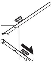
**DE** "B" zu kurz → unteren Falzanschlag nach außen schieben.
