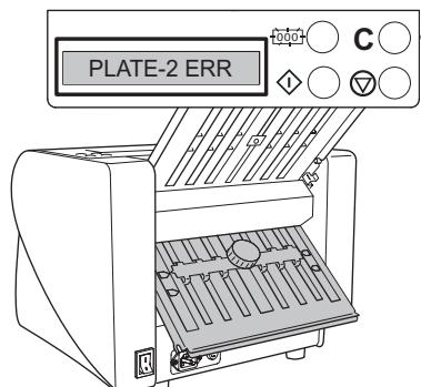
**DE Untere Falztasche korrekt montieren.
