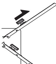
**DE** "A" zu kurz → **oberen** Falzanschlag nach außen schieben.
