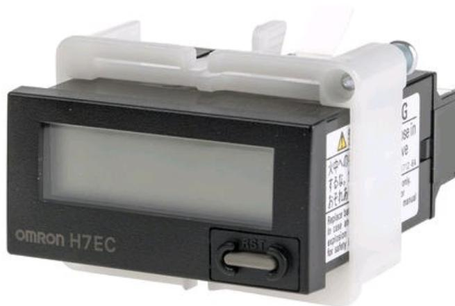
Impulszähler mit 7-stelligem LCD, 48 Hz/8 kHz mit integrierter Lithium Batterie, ohne Hintergrundbeleuchtung.
