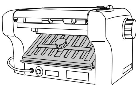
**D Der Falzanschlag der unteren Falztasche bestimmt die zweite Falzung.**
