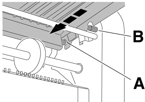
**D** **Aufstellung:** Obere (lange) Falztasche in die Zapfen (**A**) beidseitig einführen und auf die Zapfen (**B**) beidseitig auflegen.
