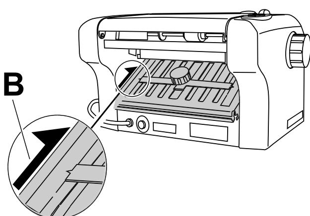
**D** Untere (kurze) Falztasche muss korrekt eingerastet sein. Führungslinie (**B**) beachten.
