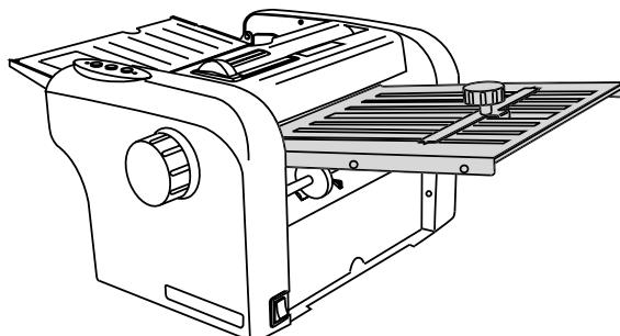
**D Der Falzanschlag der oberen Falztasche bestimmt die erste Falzung.**
