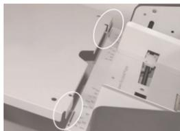
Pro umístění prodloužení na výstupní podavač nasměrujte podle obrázku výstupky na prodloužení do drážek na výstupním podavači. Pro umístění prodloužení není nutná žádná velká síla – prodloužení jsou udržována ve své poloze vlastní vahou.
